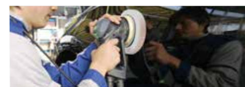
【軽研磨】 キズのエッジ部分だけを磨き取る研磨。塗装本来の輝きを取り戻す。塗装の厚みは変わらない。
